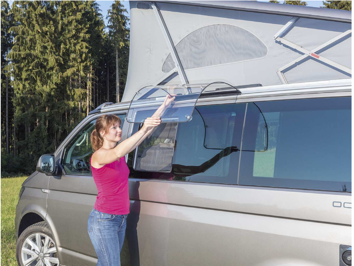
AIRSCREEN VW T6.1/T6/T5 wird in die serienmäßig vorhandene Aluschiene der VW California oder bei allen anderen VW T6.1/T6/T5 in TOP-RAIL eingezogen.
