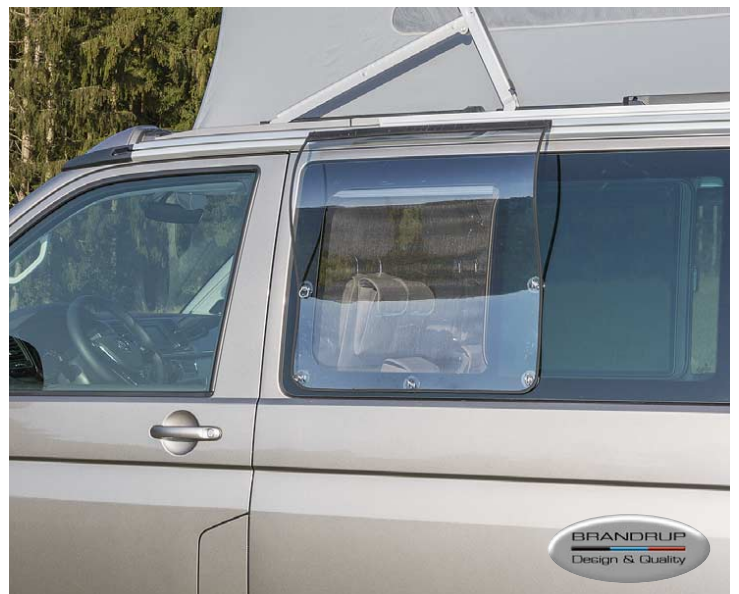
AIRSCREEN VW T6.1/T6/T5 wird aus einer besonders hochwertigen Polycarbonat-Platte („Makrolon“®) gefertigt.
